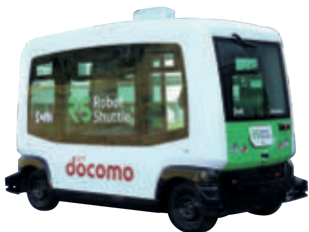
大学構内で試験走行中の「自動運転バス」は、歩行者の存在をスマホからバスに通知して安全に走る(写真提供:九州大学)
