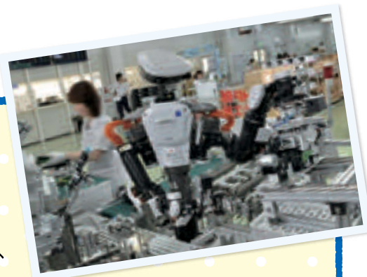
工場内で人と協力しあって作業をするロボット「NEXTAGE」 (写真提供: グローリー株式会社)
